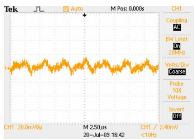
Noise V_{IN}=12V , I_O=10A , 5~20MHz Bandwidth
